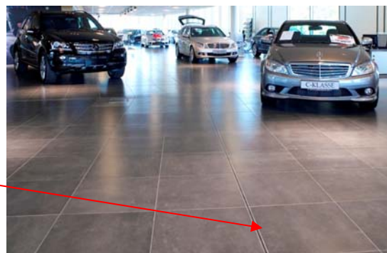
Figur 7: Metall fugeprofiler skal benyttes på flater som har rullende trafikk
