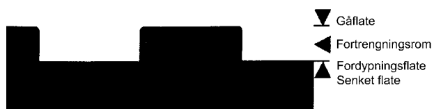
Profilert overflate med dreneringsrom
